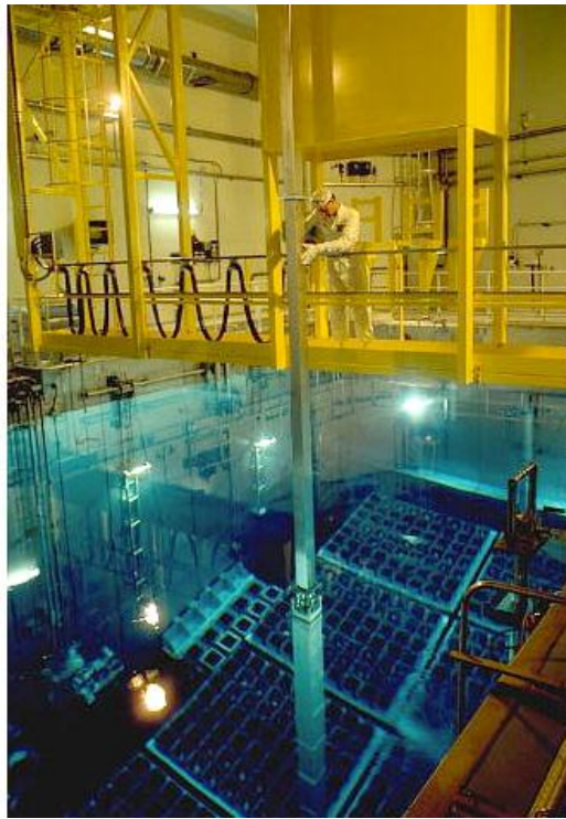
Déchargement de combustible sous eau dans la centrale nucléaire de Golfech © EDF
